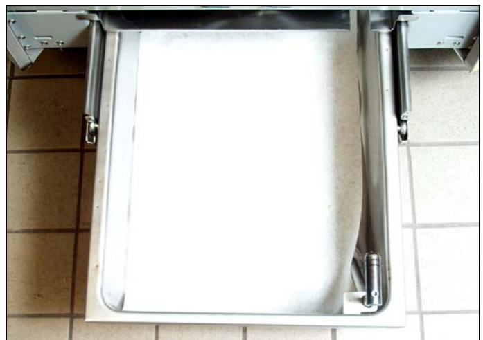
Leg een blad filterpapier of een filterkussen over de zeef. Als u een FILTERKUSSEN gebruikt moet de ruwe kant naar boven zijn gericht.
